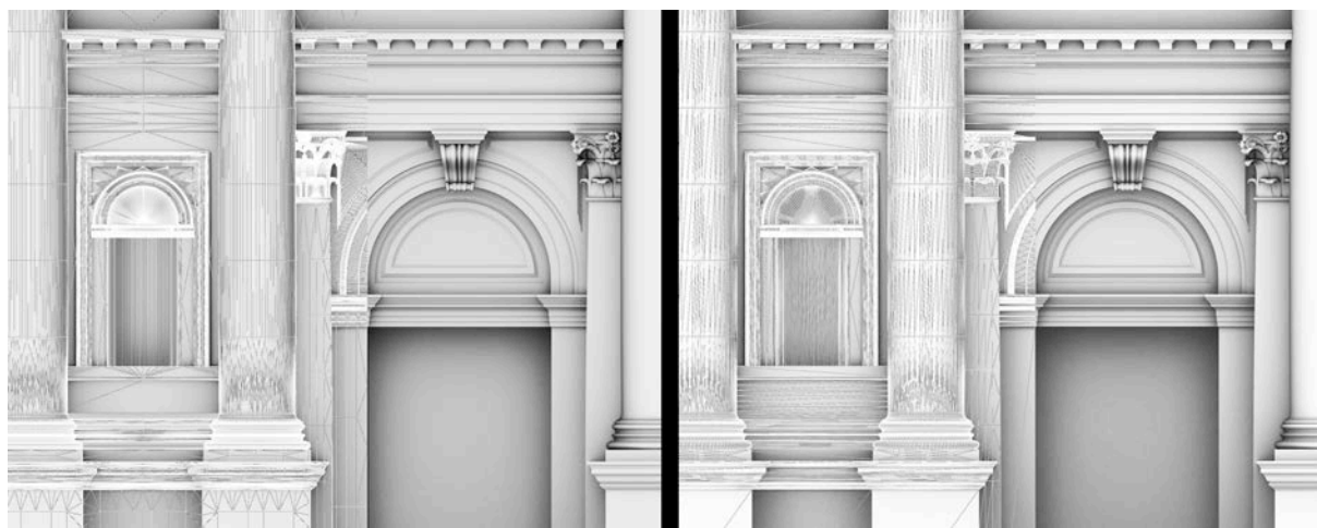
Figura 3. Particolare della facciata della chiesa di San Giorgio Maggiore. Confronto tra il modello numerico esteso (a sinistra) e modello ridotto per Google Earth (a destra). Si noti la diversa densità di facce (soprattutto nel capitello, nella nicchia e nelle parti piane) e la resa quasi identica del rendering, nonostante il modello di destra sia caratterizzato da un numero di facce pari a circa un decimo rispetto al modello di sinistra.
