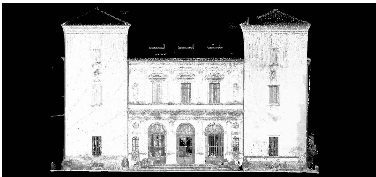
Fig. 4 Ortofoto estratta dalla nuvola di punti della facciata principale di Villa Trissino Facchini
