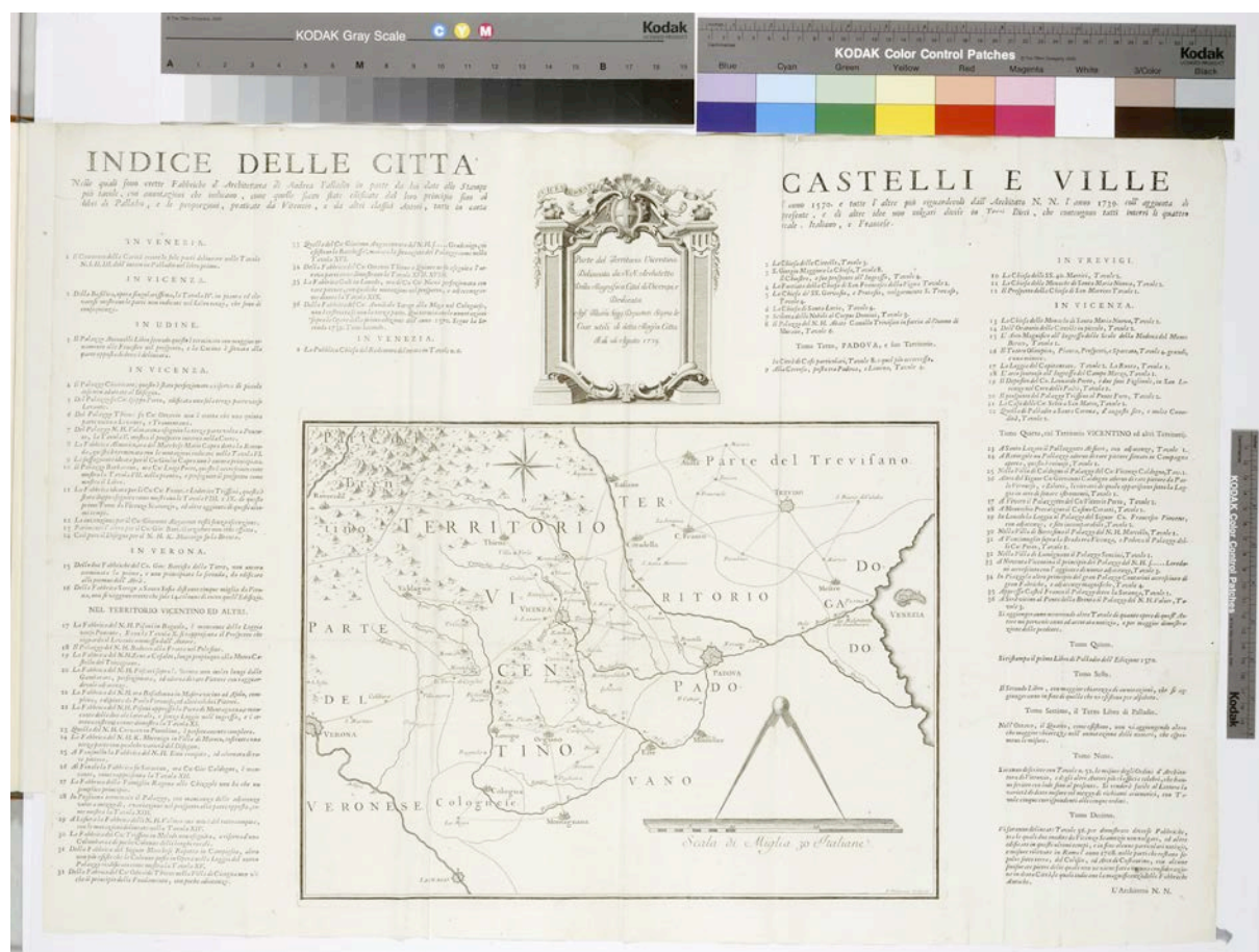
Esempio di digitalizzazione di una tavola piegata (540x780mm) tratta da Francesco Muttoni Architettura di Andrea Palladio... , Venezia 1760 con le scale metriche e cromatiche di riferimento per la calibrazione dello scanner e per la successiva validazione dei dati in fase di consultazione.
