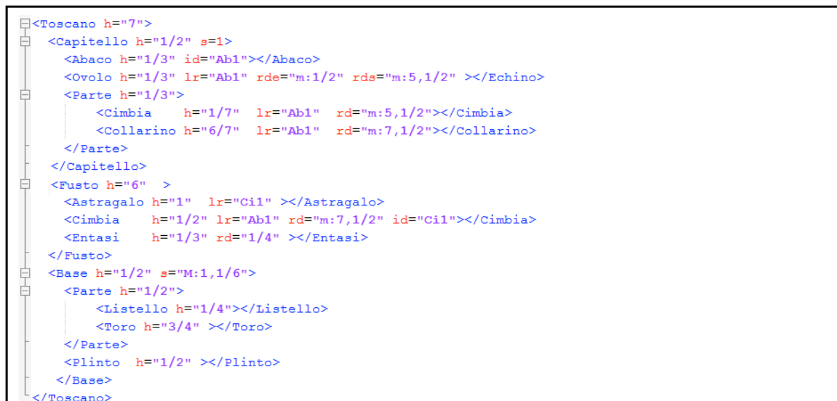
Figura 2 - Simulazione della sequenza di costruzione della definizione parametrica dell'ordine Toscano. Fase 4.
