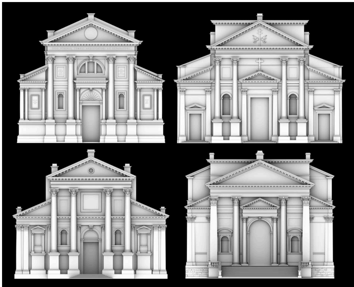
Figura 4. Prospetti, non in scala, delle quattro facciate. Rendering dei modelli per Google Earth: San Francesco della Vigna, con 502.000 poligoni triangolari; San Pietro di Castello, con 406.000; San Giorgio Maggiore, con 573.000; Redentore 595.000. I rendering e la creazione delle texture utili per l'esplorazione interattiva sono stati eseguiti con Cinema 4D con Ambient Occlusion.
