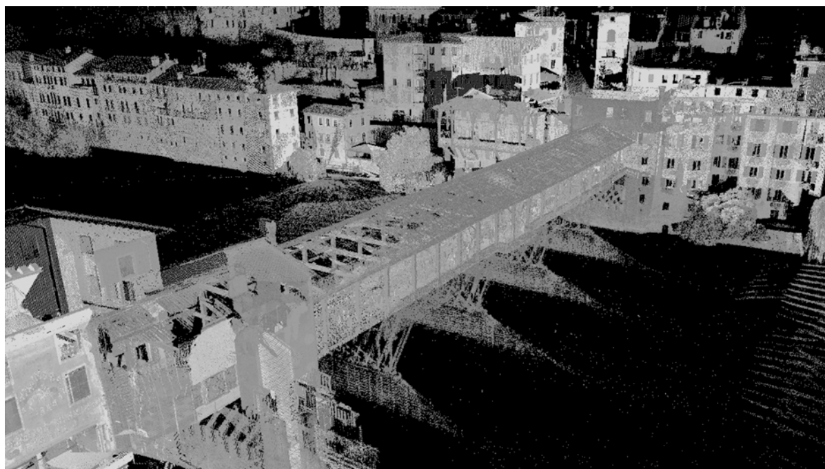
Fig. 1. Nuvola di punti ottenuta allineando le 21 scansioni effettuate.
