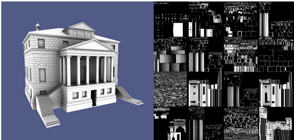
Fig. 6. Villa Foscari: il modello testurizzato in AO e le relative mappe
