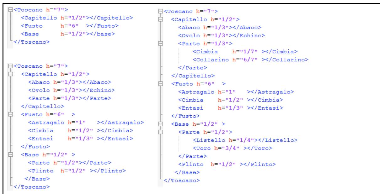
Figura 1 - Simulazione della sequenza di costruzione della definizione parametrica dell'ordine Toscano. In alto a sinistra la fase 1, in basso a sinistra la fase 2 e a destra la fase 3.
